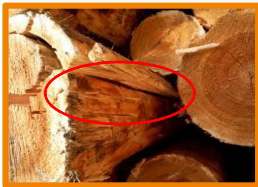
Crăpătură pe suprafața laterală
