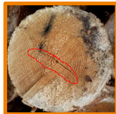
Crăpătură frontală superficială de inimă
